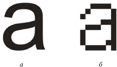
Фиг. 1 Разлика между печатния векторен вариант на буквата (а) и растеризирането на буквения знак на компютърния монитор (б). Използван шрифт Arial.
